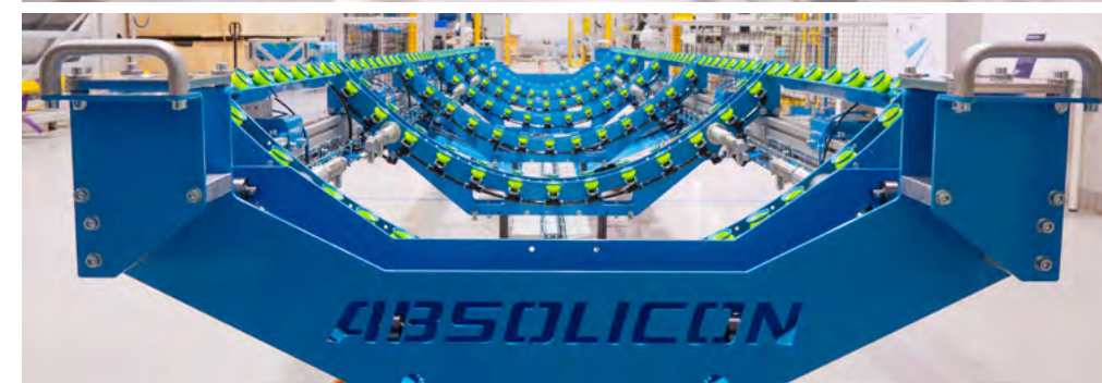
Den nya monteringsvagnen för Absolicons produktionslina uppe till vänster. Lättare, billigare och mer exakt.
