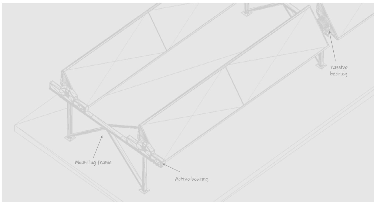
Ett utvecklat bärande element för solfångarna som innebär utökad skalbarhet och lönsamhet. Bild: Absolicon
