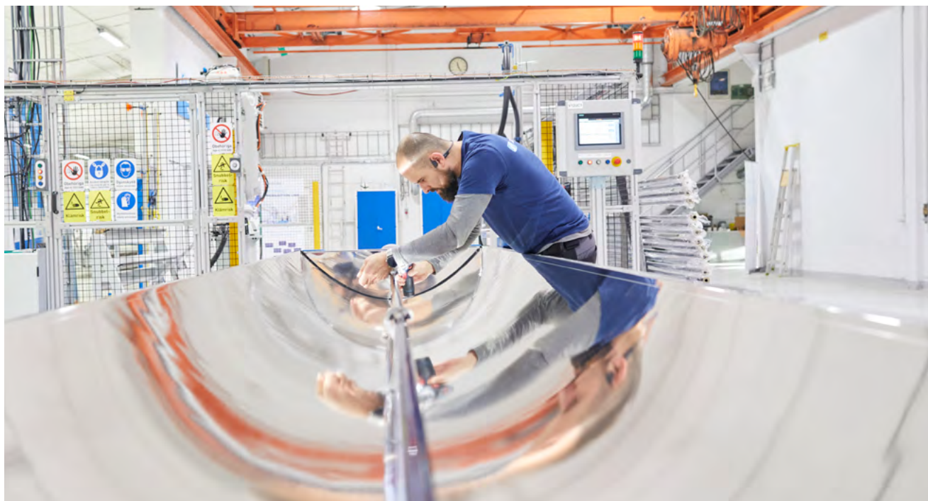
Solfångaren T160 har världens högst uppmätta optiska verkningsgrad för ett litet paraboliskt tråg. Detta beror delvis på de avancerade material som används i glas, reflektor och mottagarrör. Foto: Tarek Suleiman
