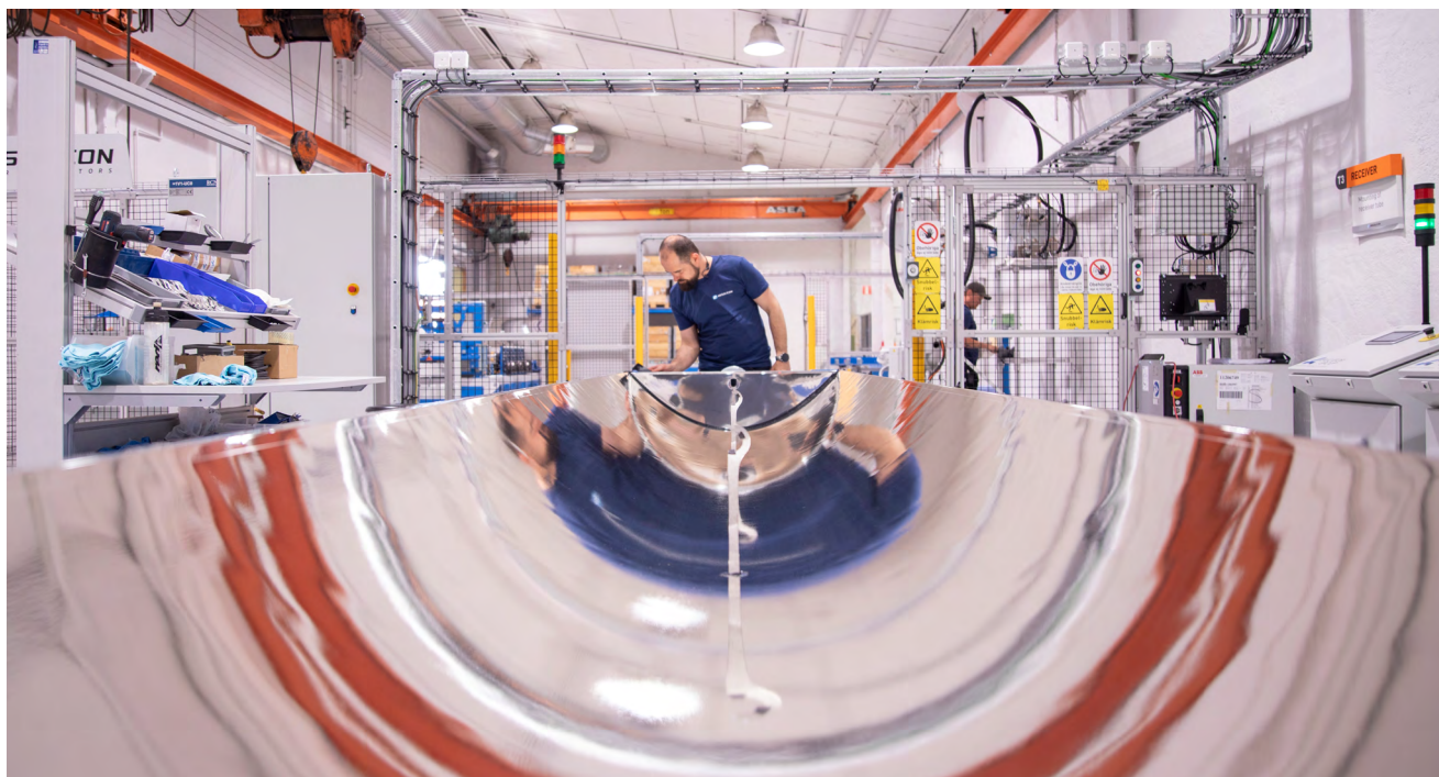
En av de kritiska komponenterna i en koncentrerande solfångare är den reflektorfilm som reflekterar solljuset på mottagarröret. Foto: ABB
